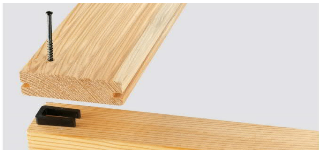
Anfangs/Abschluss-GECKO als Abstandshalter unter die erste Diele setzen. Der Quersteg muss nach oben zeigen. Anfangsdielen vorbohren.
